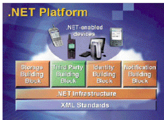
Abb. 1: In der .NET-Plattform bilden die offenen XML-Standards eine tragende Säule, auf der die komplette .NET-Infrastruktur ruht. Mit Hilfe dieser Infrastruktur ist die Entwicklung erweiterter Dienste möglich. Der Zugriff auf diese Dienste wiederum soll über beliebige Endgeräte möglich sein.
