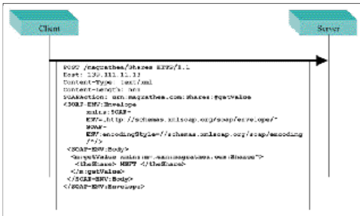
Abb. 3: In SOAP werden Methodenaufrufe als Datenpakete in XML kodiert und als HTTP-Pakete über die Leitung verschickt. Neben HTTP sind beliebige Transportprotokolle als Transportmedium nutzbar.
